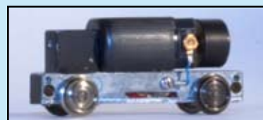
Färdigbyggt underrede för DC analogt utförande.
